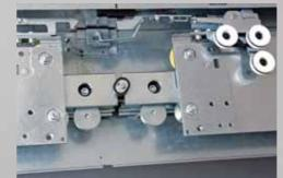
bei hoher Belastung nahezu unmöglich ist. Die schnellen Hängerplatinen wurden auf den rauen Industrieeinsatz angepasst, indem die Materialstärke im Bereich der Lauf- und Gegendruckrollen auf 6 mm erhöht wurde.
